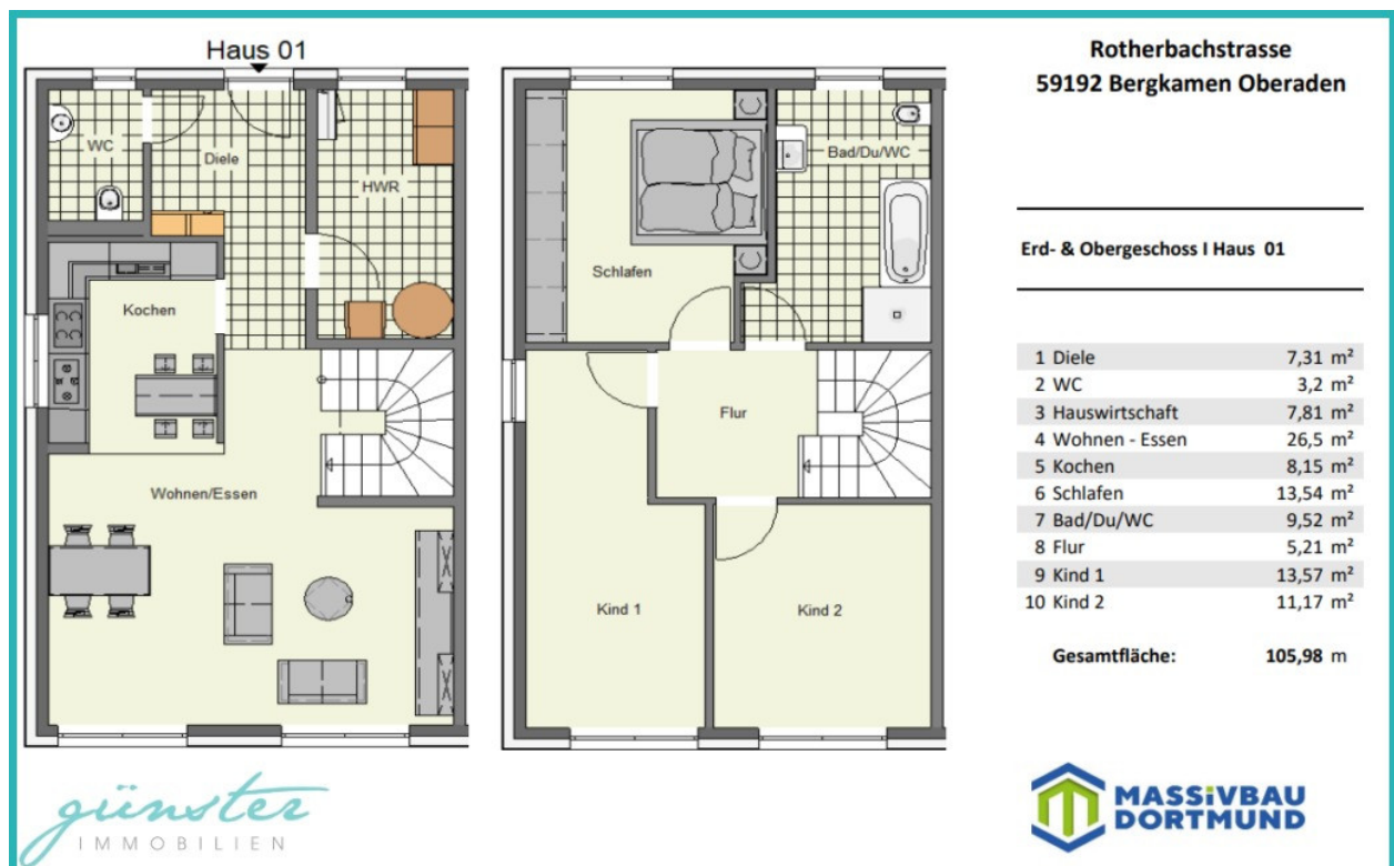
Grundriss Reihenendhaus 01+06 - nicht maßstabsgetreu
